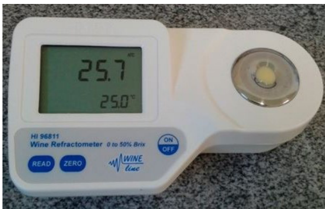
Figura 1 – Refratômetro de brix digital para avaliar a qualidade do colostro
