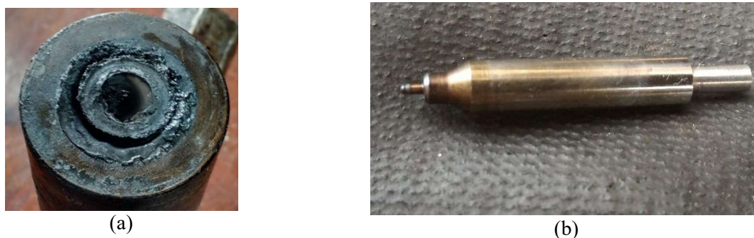
Figura 2. a) carbonização no bico injetor; b) indicativo de super aquecimento do bico injetor.
