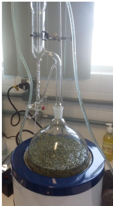
FIGURA 2- Aparato de Clevenger utilizado na extração de óleo essencial de Eucalyptus saligna .
