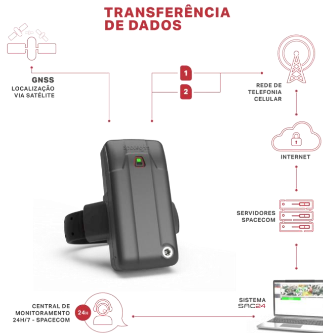
FIGURA 7 – Especificações de funcionamento e transferência de dados da tornozeleira eletrônica
