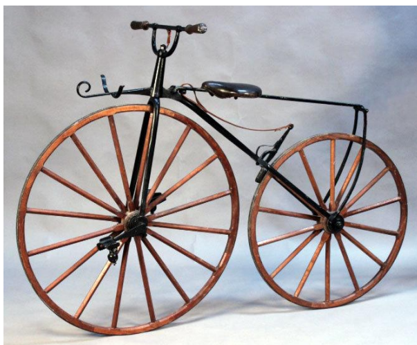
Figura 5: Velocípede por Pierre Michaux et Cie de Paris, França, por volta de 1869. (reproduzido de e Online Bicycle Museum [1])
