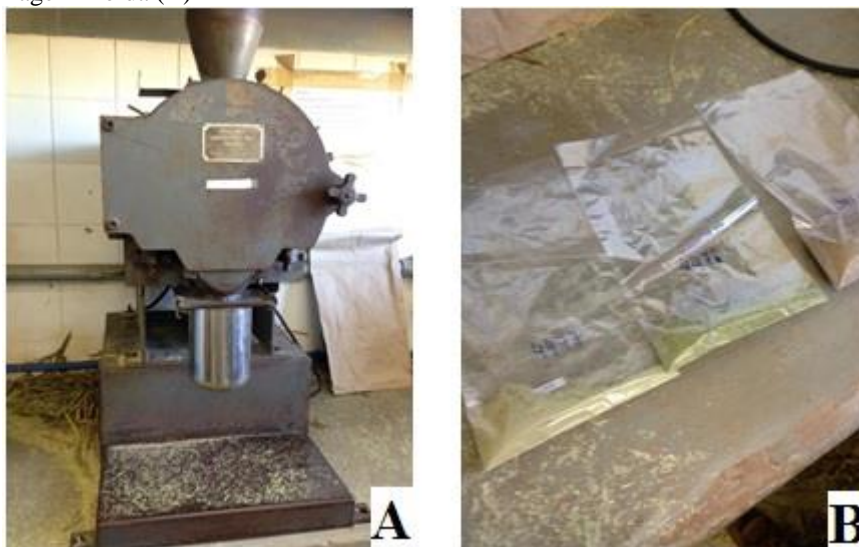
Figura 15 – Moinho utilizado para moagem das amostras (A) e algumas amostras ensacadas contendo forragem moída (B)
