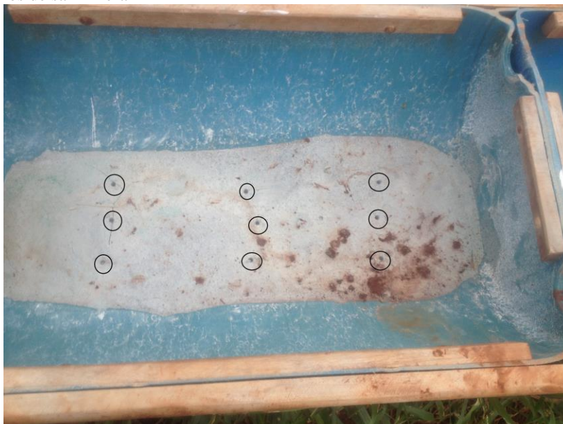
Figura 4 – Identificação dos nove pontos diferentes da medida com o penetrômetro que eram feitos nos cochos de sal mineral
