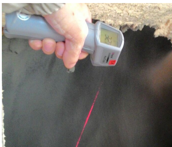
Figura 1: Termômetro a laser para verificar a temperatura da matéria prima
