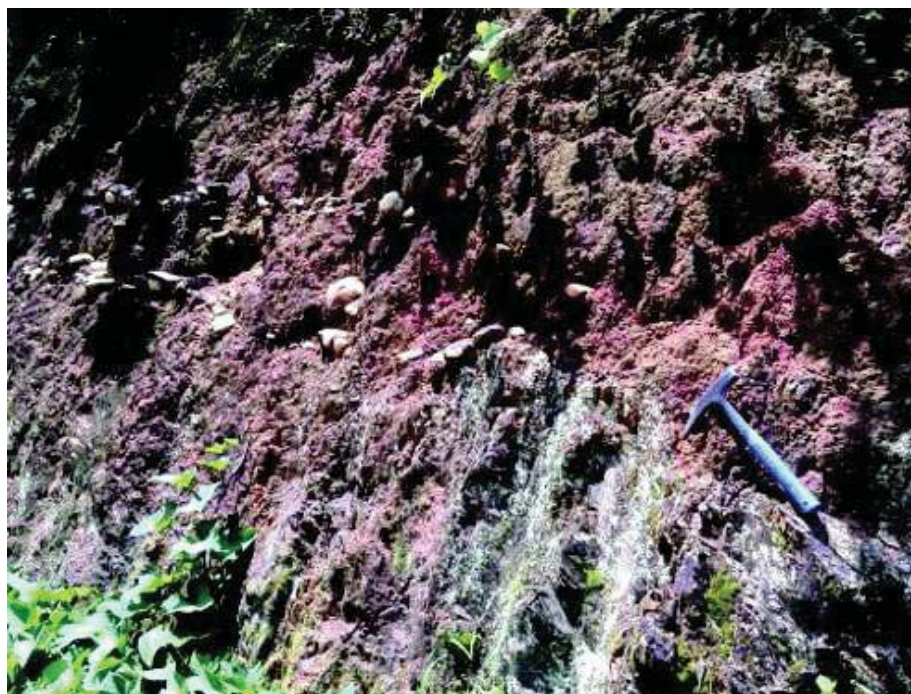
Figura 17 – Aspecto do contato solo transportado x rocha alterada (saprolito) (P140).
