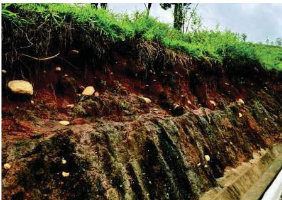
Figuras 24 e 25 - Exposição de solo transportado sobre saprólito de rocha metamórfica, com a presença de água vertendo na interface rocha x solo, em frente ao local com degraus de abatimento a montante. A camada de solo sobreposta tem forma lenticular. Os grânulos, seixos e blocos de quartzo são abundantes, dispersos no solo (P178 e P180).
