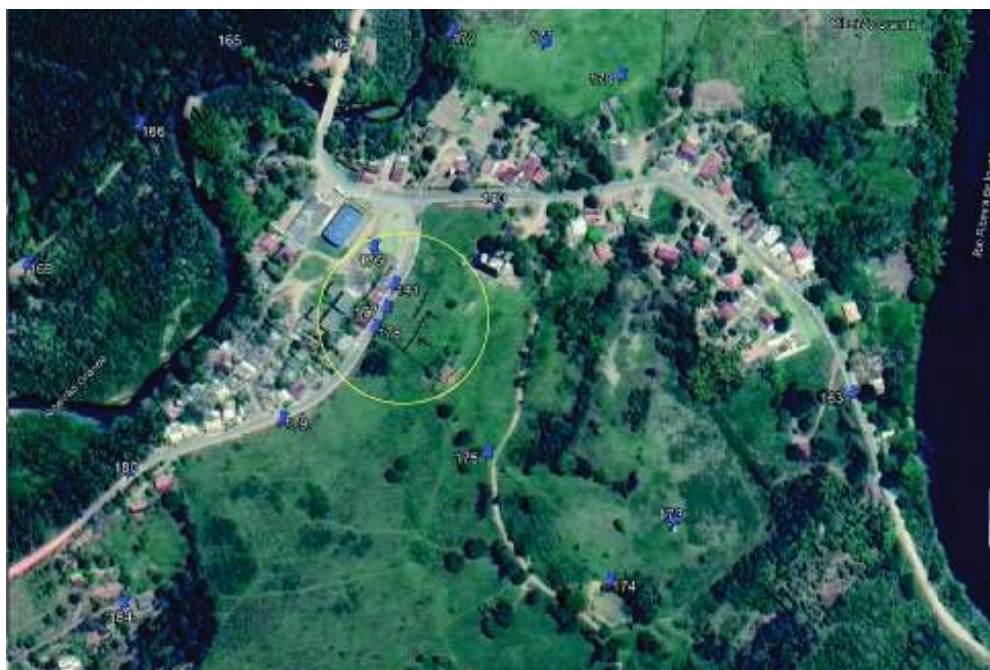
Figura 22 – Local com degraus de abatimento na encosta a leste da área edificada (círculo), próximo dos pontos 141, 177 e 178, indicativo de movimento gravitacional de massa dos solos no sentido noroeste, com residências no lado oposto da estrada.
