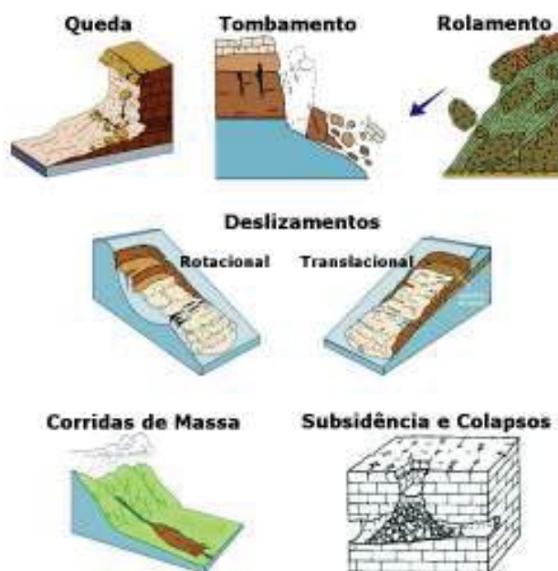
Figura 19 - Modelos esquemáticos de movimentos gravitacionais de massa (Cemaden, https://www.gov.br/ceaden/pt-br/paginas/ameacas-naturais/movimento-de-massa ).
