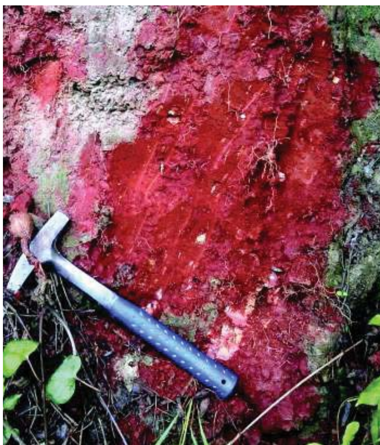
Figura 12 – Solos transportados (colúvios) em corte de estrada, com grânulos e fragmentos de quartzo imersos na matriz argilosa, com teores significativos de ferro (cor avermelhada). (P156).
