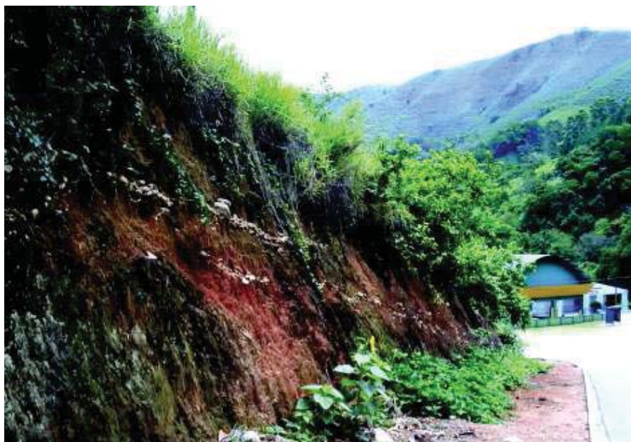
Figura 16 Aspecto de solo transportado com linhas de seixos (stone-lines) sobre exposição de rocha metamórfica alterada (proximidade da área urbana central do Distrito, P140).
