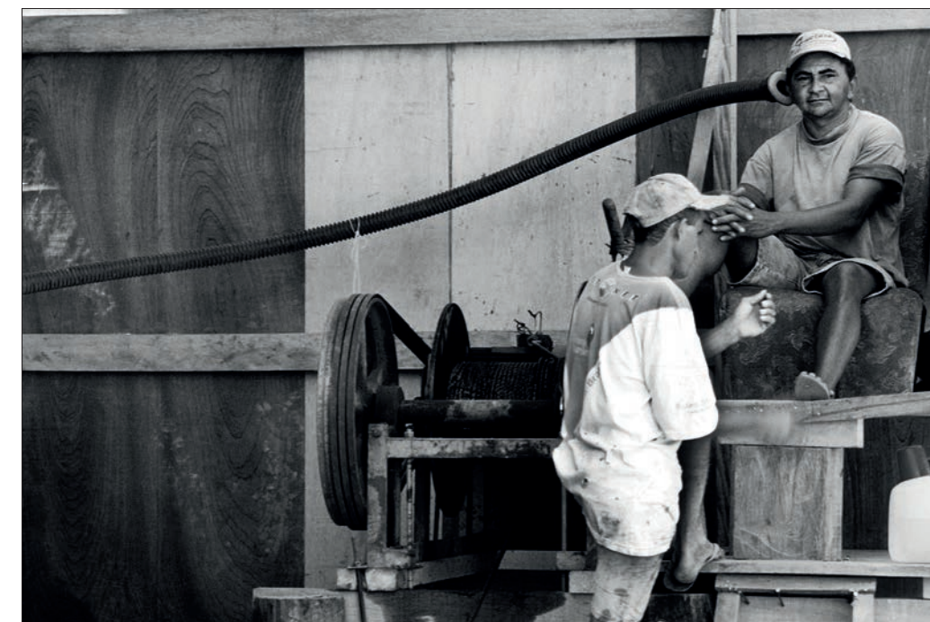
Sistema de transporte de mineradores por cabos de aço em poços, em garimpo de esmeraldas, e a comunicação por tubos. Monte Santo, Tocantins – 2002.
