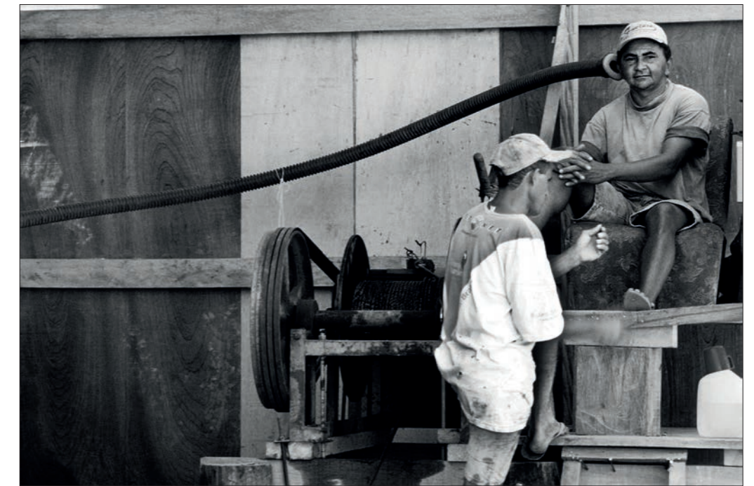
Sistema de transporte de mineradores por cabos de aço em poços, em garimpo de esmeraldas, e a comunicação por tubos. Monte Santo, Tocantins – 2002.
