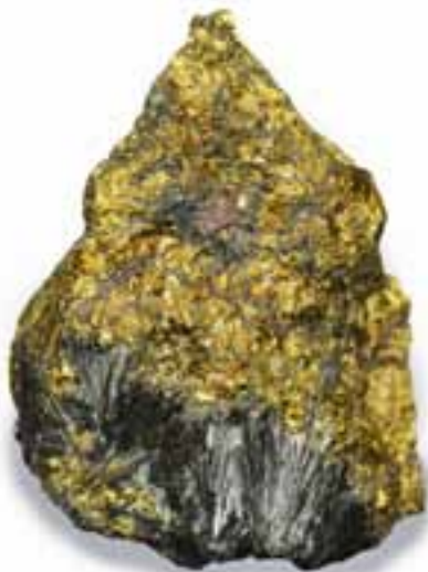
Calcopirita (amarela) com anfibólio da Mina do Sossego (onde se obtém principalmente cobre e ouro), em Carajás, Pará.
