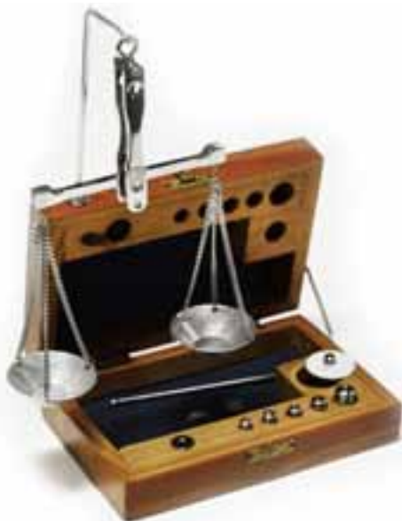
Balança de madeira utilizada na pesagem de gemas, produzida na década de 1970. Atualmente são utilizadas balanças eletrônicas que se tornaram mais baratas e precisas. Coleção e imagem: Liccardo.
