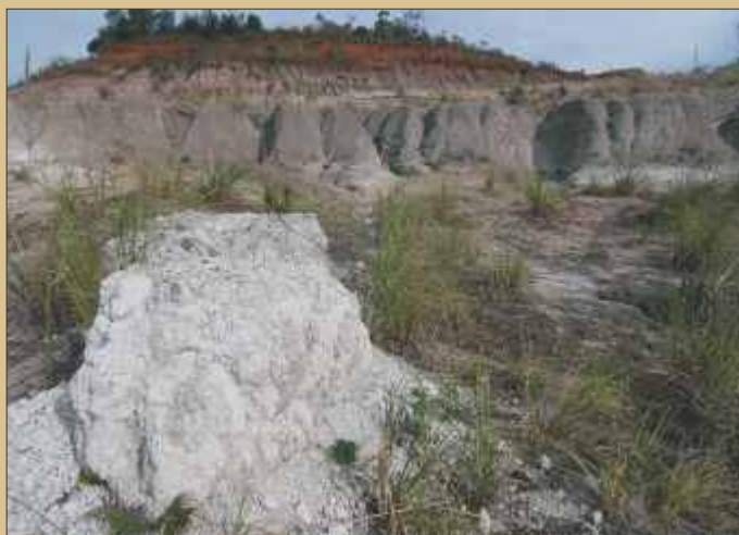
Vista de um perfil típico da Bacia de Curitiba, com caliches brancos em primeiro plano e argilitos ao fundo sobrepostos com lentes de arcósios. Em cima, camada de solo avermelhado típico.
