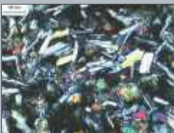
Imagens do mármore dolomítico (claro) e do diabásio (escuro) no pavimento e observadas em microscópio.
