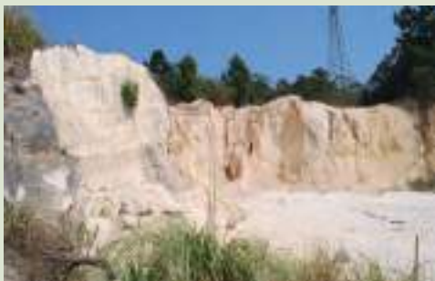
Uma das saibreiras em quartzitos do município. O quartzito, devido à sua resistência, é muito utilizado como revestimento em estradas.
