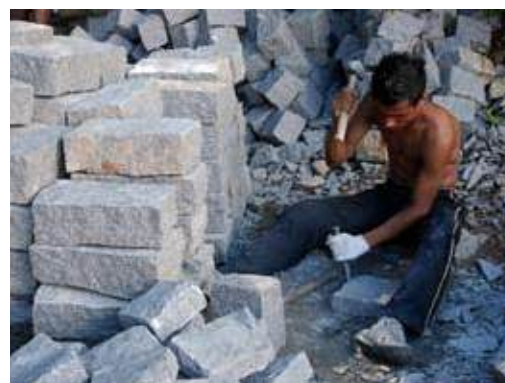
Canteiros formando paralelepípedos e lousas de granito em Quatro Barras. Os blocos são cortados manualmente com o macete ou marreta, ponteiros, cunhas e cinzéis ou talhadeiras.
