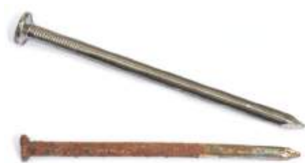
Exemplo de oxidação sofrida por ferro quando exposto à atmosfera e à umidade.
