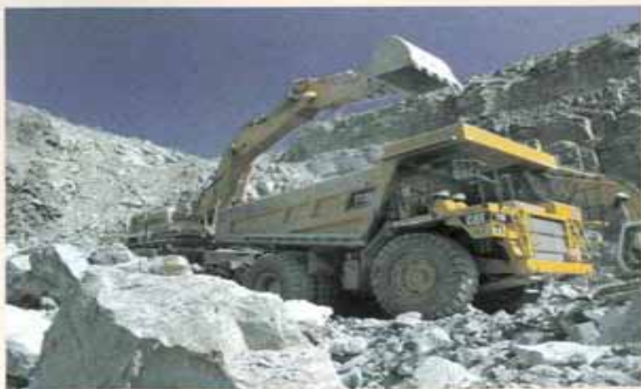
Foto maior: afloramento de siltito/argilito na região de Prudentópolis, de onde se extrai o barro para tijolos e telhas. Cerâmica Gnatta. Acima: extração de calcário calcítico para fabricação de cimento da empresa Votorantim em Rio Branco do Sul.
