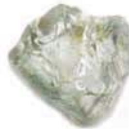
Quartzo mostrando fratura conchoidal
