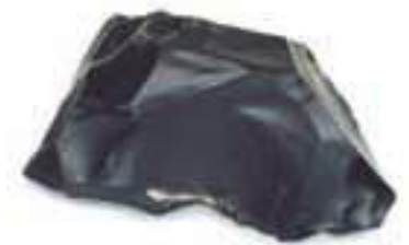
A obsidiana é um vidro vulcânico que também apresenta fratura do tipo conchoidal
