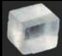
Clivagem muito boa em três direções na calcita
