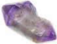
Hábito prismático terminado em duas pirâmides – quartzo
