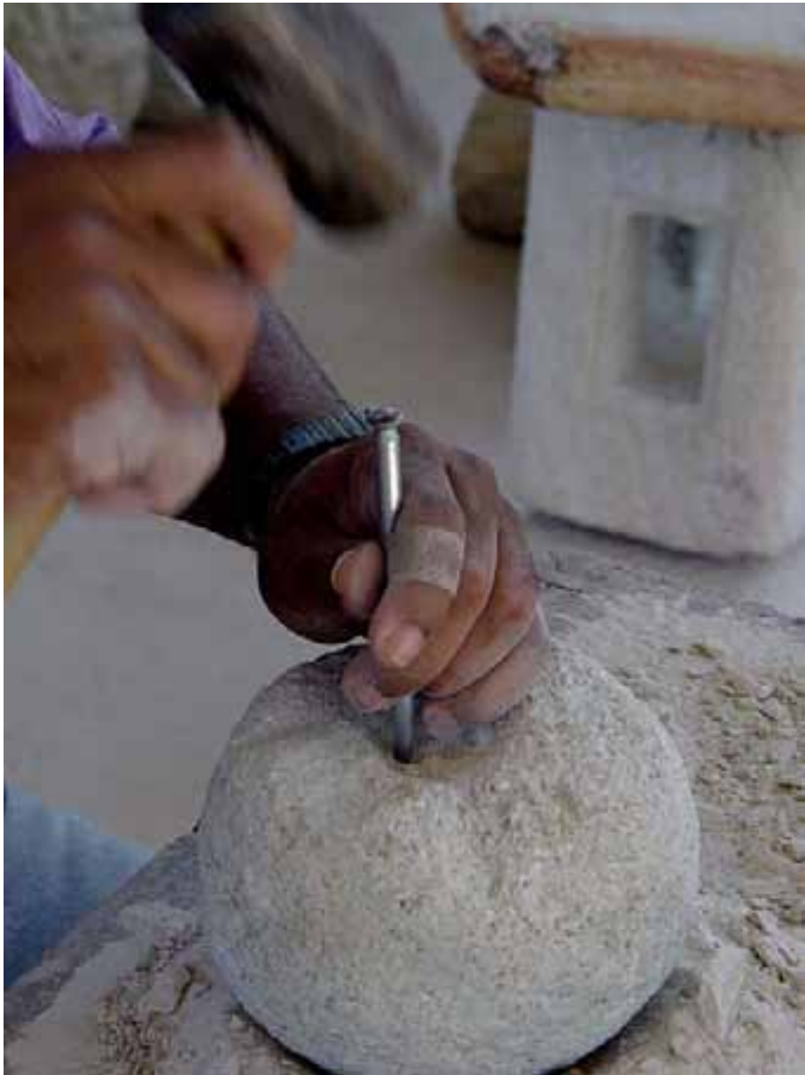
Canteiro perfurando rocha com punção e marreta
