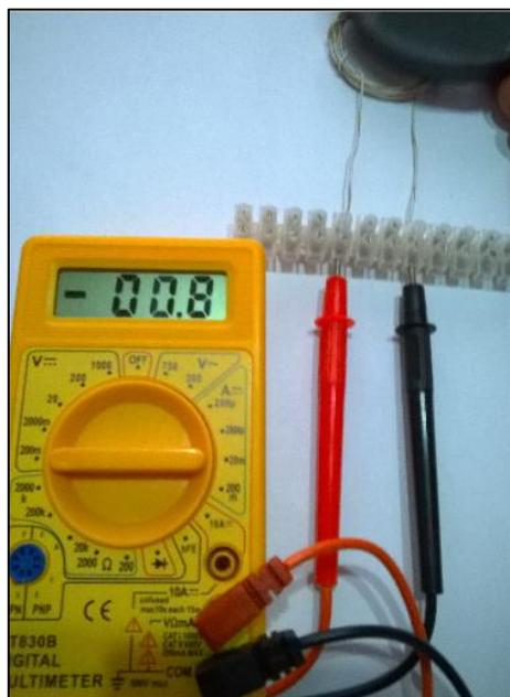
Figura 47 – Medindo a tensão produzida pelo afastamento do imã em relação à bobina –
