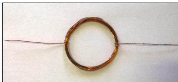
**Figura 39 – Bobina motor elétrico – Fonte: O autor**
