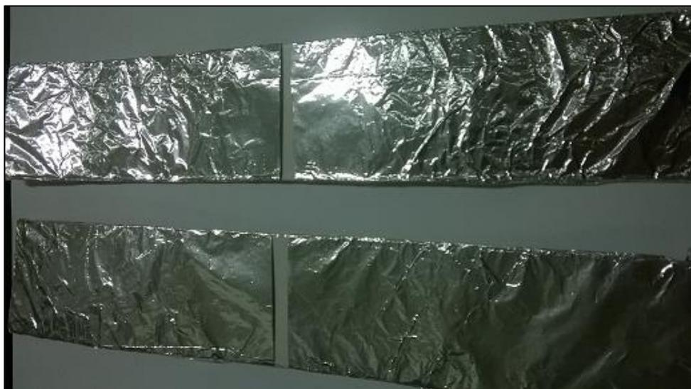
Figura 52 – Antenas do transmissor – Fonte: O autor
