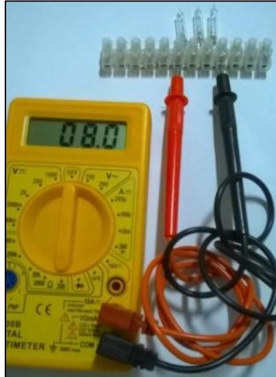
**Figura 28 – Medida da resistência das lâmpadas – Fonte: O autor**
