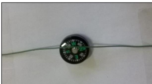
**Figura 37 – Experiência de Oersted – Bússola sob o fio sem corrente – Fonte: O autor**
