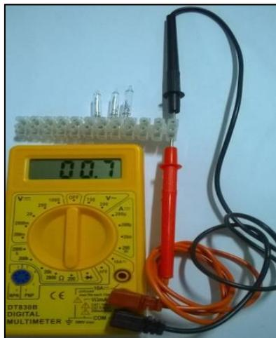
Figura 25 – Medida da resistência de curto – Fonte: O autor
