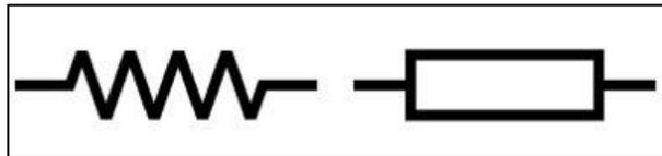
Figura 21 – Representação gráfica padrão de um resistor – Fonte: O autor
