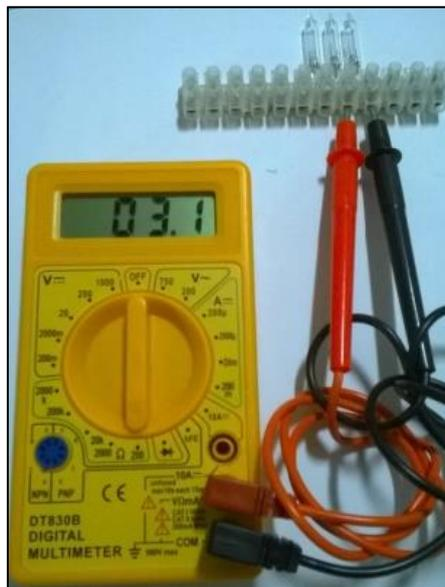
Figura 27 – Medida da resistência das lâmpadas – Fonte: O autor
