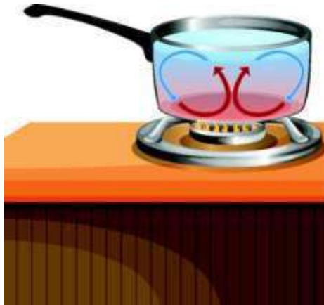
Figura 11: Transferência de calor por convecção
