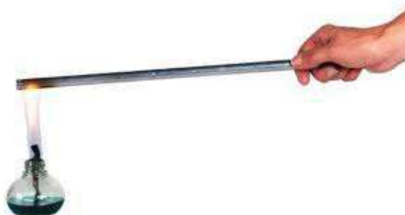
Figura 10: Transferência de calor por condução
