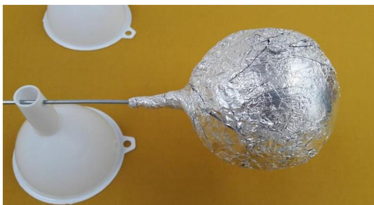
b) detalhe da esfera de isopor envolvida por filme de alumínio
