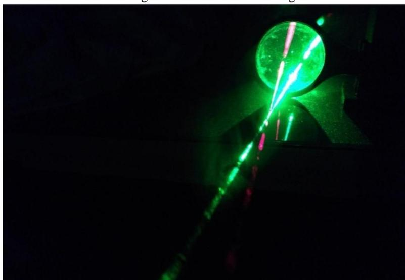
Feixes de luz laser convergindo em uma lente convergente vista da direção contrária à de propagação do feixe de luz. Fonte: Autor.
