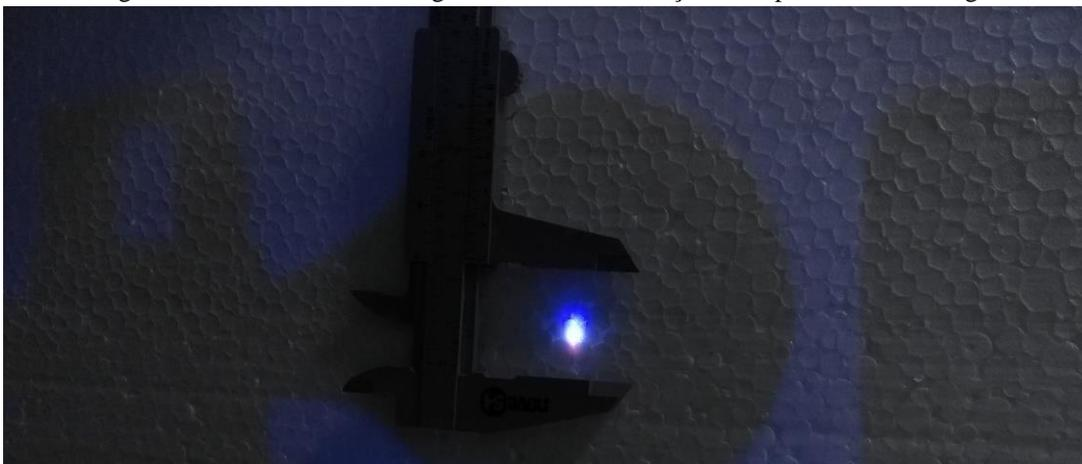
Condição do experimento da fotografia 7 em que um paquímetro é mantido com a dimensão da distância de separação entre os led's extremos da configuração do iluminador. Fonte: Autor.
