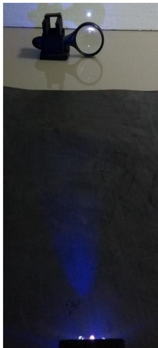
O material preto e fosco foi colocado sobre a superfície da mesa para eliminar a luz refletida na superfície.
