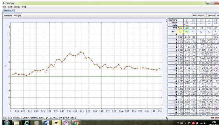
Analisando o gráfico do movimento no eixo y em relação ao tempo, presente na figura 54, vemos uma descrição fiel da trajetória do móvel, que foi solto de 1,53 m de altura, chegou na parte mais baixa da rampa, onde a posição na coordenada y é igual a zero metros, e depois voltou a se elevar até a altura de 0,80 m após saltar da inclinação final da rampa. Após o salto, o móvel sofre a queda imposta pela aceleração da gravidade local.
