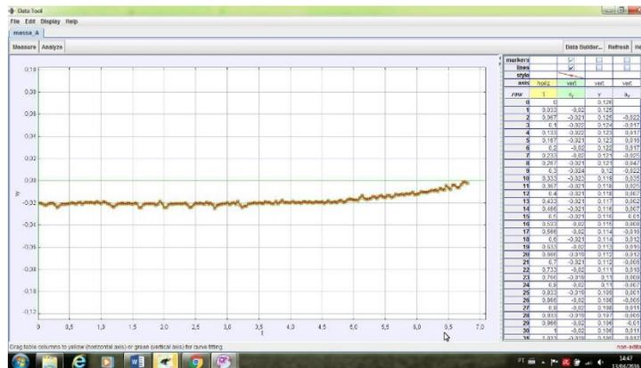
No gráfico da velocidade no eixo y versus tempo vemos que a velocidade permanece constante e com valor de 0,02 m/s na maior parte do movimento. Depois de 6 s a velocidade foi diminuindo devido aos efeitos de borda sentidos pelo dado, ao se aproximar do fundo da proveta. Entretanto fica claro que a velocidade no movimento uniforme permanece como uma constante quando nenhum efeito externo impõe influência no objeto em movimento.
