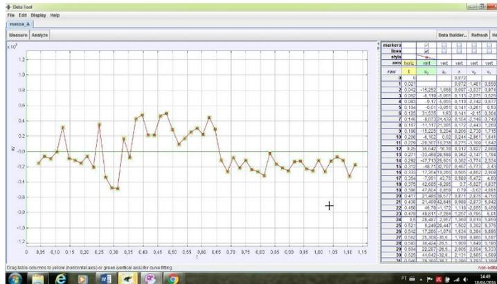
Na figura 52 temos a plotagem da velocidade no eixo y e em relação ao tempo decorrido do movimento. Na mesma figura, o móvel tem velocidade igual a zero no eixo y no tempo 0,50 s. É mais claro ainda o momento que o móvel deixa a rampa, que ocorre no tempo de 0,65 s. Após este instante a velocidade em y vai aumentando com o tempo devido a ação da aceleração da gravidade após o móvel ser lançado.
