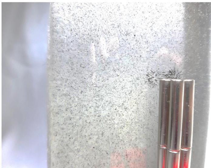
Limalha dentro da garrafa com líquido viscoso submetida à campo magnético
