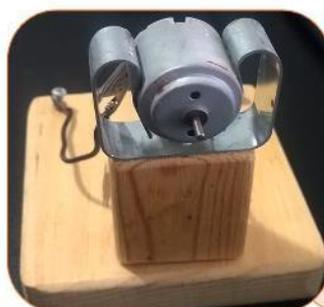
Para os motores elétricos, foi construído uma pequena base de 45 x 35 mm, com a mesma madeira, para que ficasse um pouco mais anatômico e fácil de utilizar, além de uma abraçadeira metálica. O modelo não precisa ser exatamente o que foi utilizado, contanto que fixe o motor a base.
