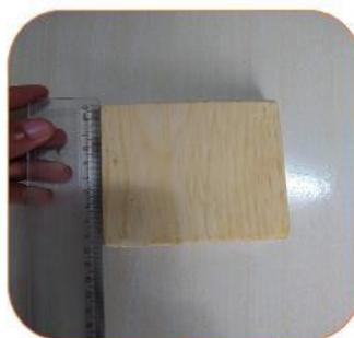
Corte e lixe um pedaço de Madeira ou MDF 15 mm, formato retangular, com 100 mm de comprimento e 85 mm de largura. Essa parte pode ser feita manualmente ou pode-se terceirizar. No total para o Kit foram utilizados 37 unidades.
