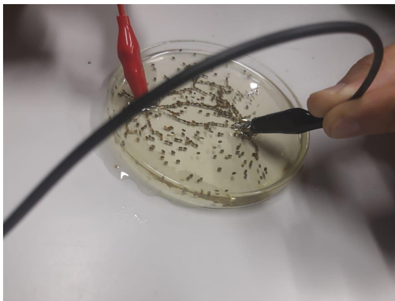
Figura 15 – Aparato, pontas carregadas em azeite (isolante) onde flutuam sementes de grama.
