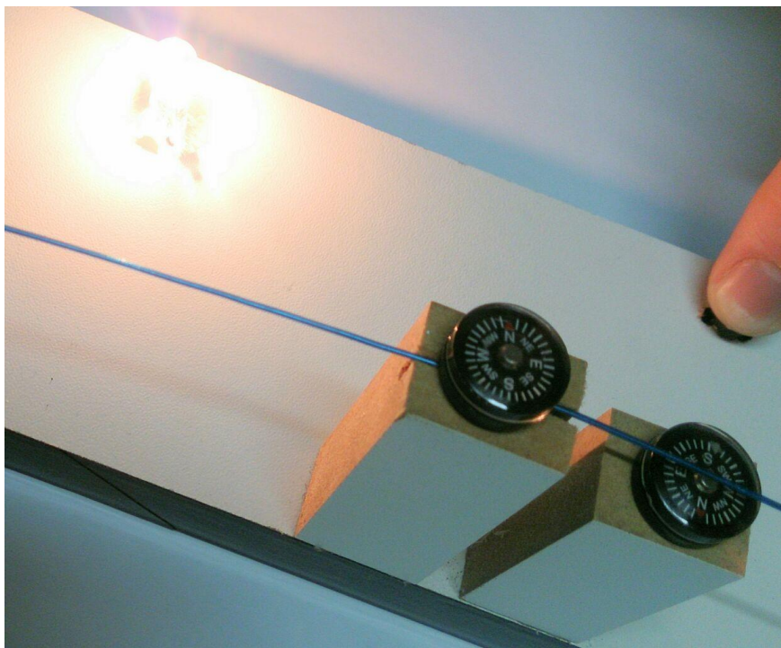
Imagem 5 - Comportamento das bússolas quando corrente elétrica contínua percorre o circuito
