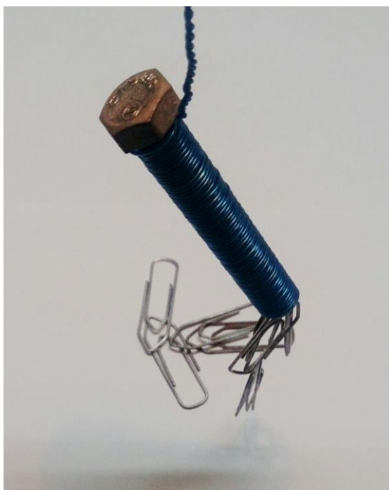
Imagem 8 - Eletroímã em funcionamento
