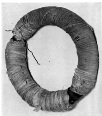
Figura 4 4 – Foto do anel de ferro, utilizado por Faraday em suas experiências de 1831.
