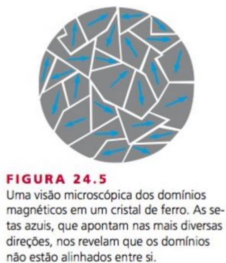
Figura 2 - Ilustração dos domínios magnéticos
