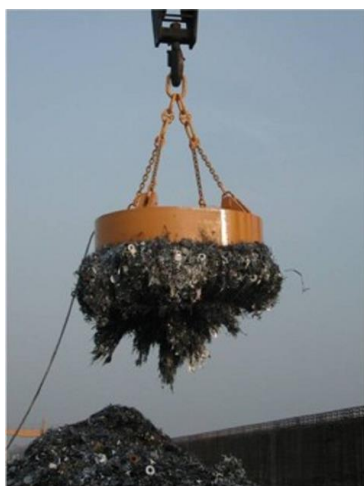
Figura 1 13 – Eletroímã em utilizado em ferro velho.
