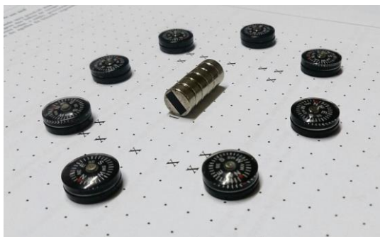
Imagem 2 - Registro do comportamento das bússolas próximas ao campo magnético dos ímãs
