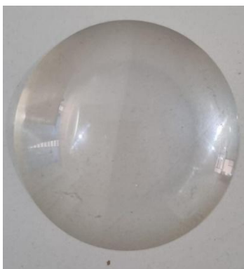
Figura 12 – Lente convergente que simula o cristalino
