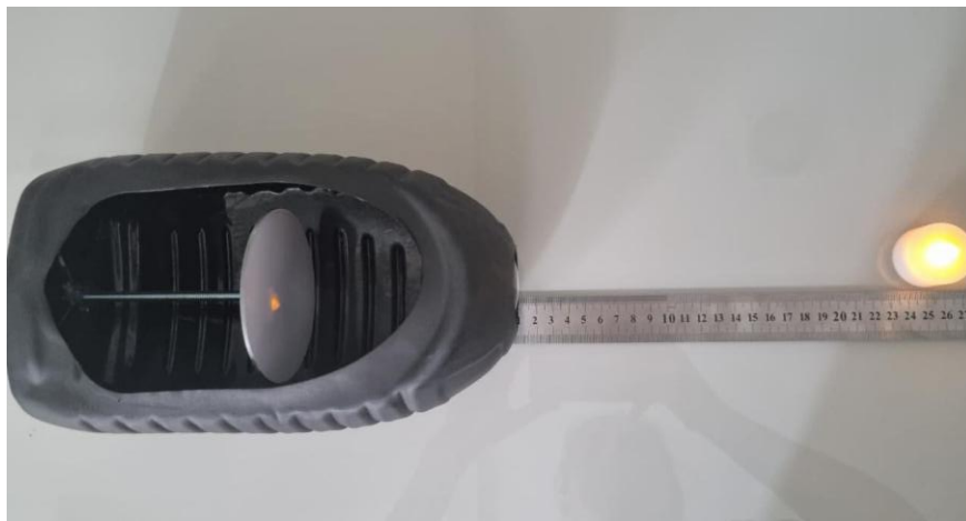
Figura 12 - Simulador físico do olho humano
