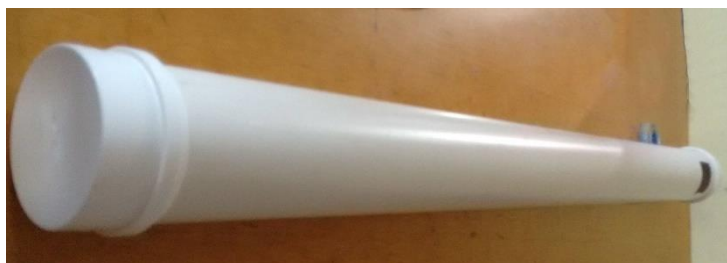
Figura 33 - Montagem da câmera Solar de PVC . Fonte o Autor, 2016
